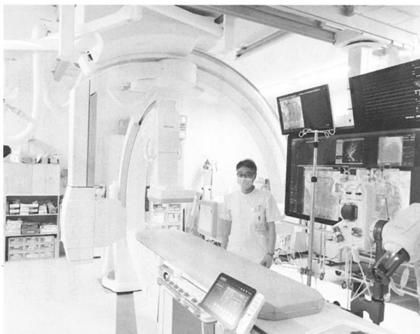
一度に縦横2方向からの撮影が可能な血管撮影装置
