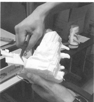
出来上がった模型は余分な素材を取り除いて完成する。精度は極めて高いという
